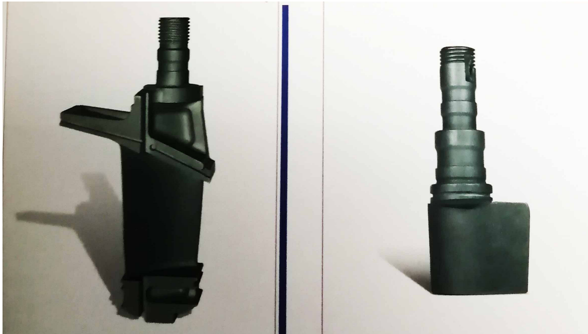
شکل ۲-الف-پره ثابت ردیف ۱ توربین کمپرسور (ct)-توربین شکل ۲-الف-پره ثابت ردیف ۲ توربین کمپرسور (CT)-توربین
